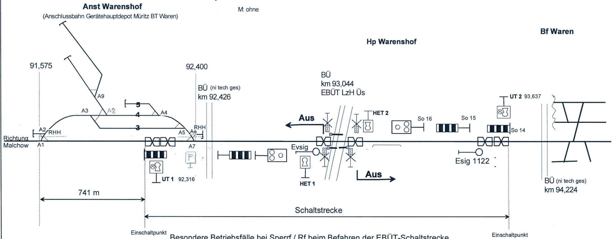
Besondere Betriebsfälle bei Sperrf / Rf beim Befahren der EBÜT-Schaltstrecke
